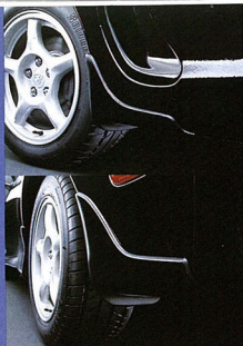
▲マッドフラップ フロント用、リヤ用各1万4600円 タイヤの跳ね上げる小石、ピッチ、泥などからボディを守る。ボタニ色に合わせて用いる。
