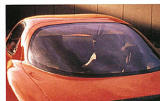
▲88年3月に完成した樹脂モデル。旧型シャシーを利用した実走可能なモデルであり、テストコースで動態評価された。
