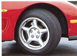
▲16インチ・8Jサイズでは、世界最軽量のスロッドホイール。
