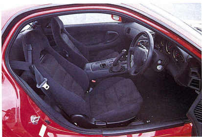
▲新しい製造方法を探り入れて軽量化を図ったハイバックシート。形状、ホールドットともに文句なし。写真のタイプFでは、表皮がラックスエードになる。
