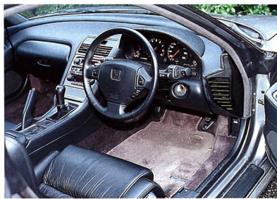
▲NSXのコックピット。シートポジションが低く、視界も下の方に広がって、レーシングカーの見え方に似ている。
