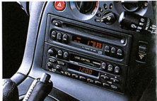
▲CDデッキシステム 6万3000円 タイプX標準装備品と同一のシングルCDデッキ。トランクスペースを重視するなら、CDチェンジャーシステムがよりベスト。パナソニック製。8cm・12cmCD対応。
