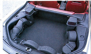
▼総延長2.7mの屈曲した共鳴ダクトとスーパーブーラー
