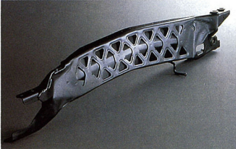
▲新型RX-7のパワーユニットとリアデファレンシャルは、パワープラントフレーム (PPF) によって結合され一体化されている (写真の黄色いフレーム部分)。このPPFのメインフレームは、十分な強度を得るため高張力鋼板で造られ、軽量化のために大断面軽減孔が開けられている。
